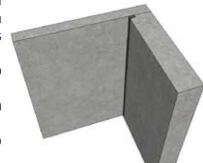
FIGURA 5: Empacado de la chaveta (keyway)
